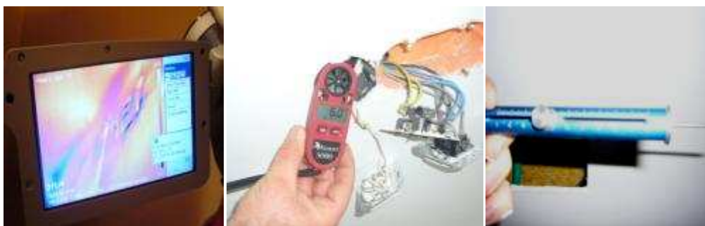
Fig. 36 Diferent maquinari per a la lectura de calor superficial en una façana mitjançant càmera termogràfica, o lectures de velocitat de circulació d'aire per l'interior de cambres d'aire. Font ADIGSA
