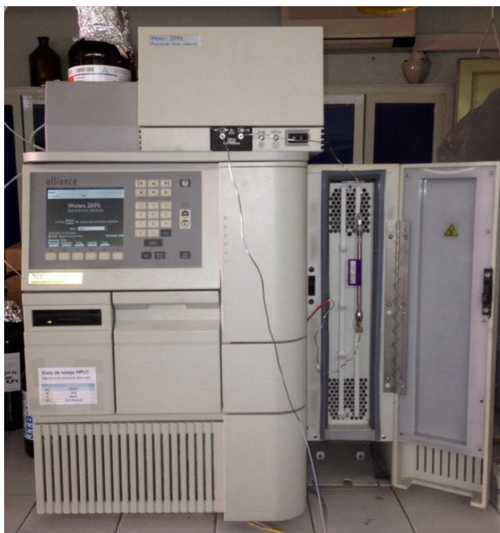
Figura 13. Cromatògraf Alliance HLPC amb una columna XBridge C 18 de 3,5 µm y 15 cm de llargada
