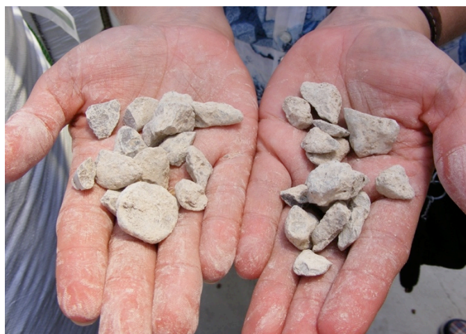
Fotografía 4. El medio granular deben estar libre de finos para reducir el riesgo de colmatar el sistema. Ángel Gallegos ©.
