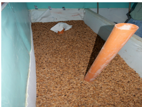
Fotografía 44 y 45. Las diferencias entre el medio granular de los humedales horizontales permitirán comparar la eficiencia de remoción del sistema entre el sustrato tradicional como grava y un subproducto de otras actividades como el corcho. Fuente: J. Morató.
