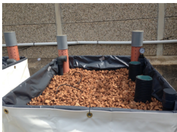
Fotografía 26. Vista del humedal con medio filtrante de corcho. Fuente: L. Aguilar.
