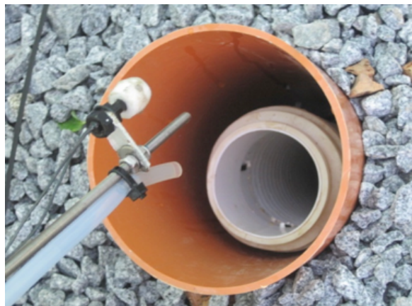
Fotografía 42 y 43. Tuberías de recolección de agua y sensores de nivel en los humedales horizontales. Fuente: A. Gallegos.
