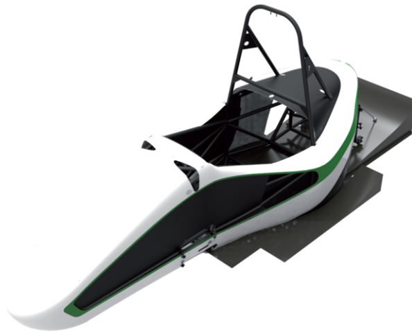
Imatge 6. Carrosseria feta de material reciclable
